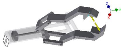
Рис.1 - схема механизма схвата и 3D модель
